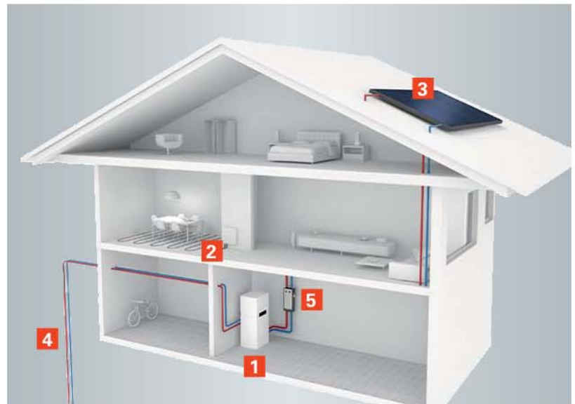
Sole/Wasser-Wärmepumpen-Kompaktgerät Vitocal 343-G mit Solaranlage
