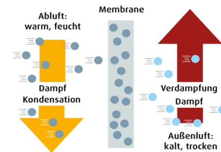
Zusätzlich können diese auch mit einer Feuchterückgewinnung ausgestattet werden. Der optional einsetzbare, neu entwickelte Enthalpietauscher überträgt einen großen Teil der Luftfeuchtigkeit aus der Abluft
